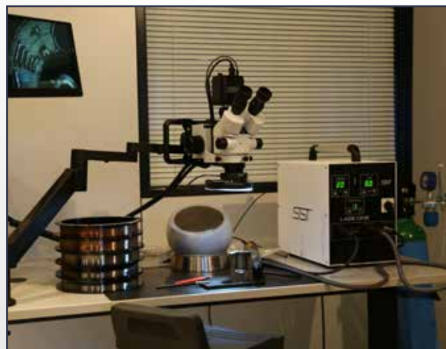
LASE ONE - Macchina per microsaldature per ogni materiale con qualità laser
