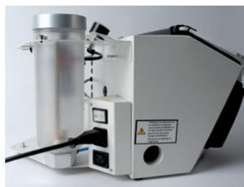
Microsabbiatrica molto ben progettata. I diversi contenitori dei materiali di sabbatura possono essere cambiati in maniera semplice e veloce a seconda delle esigenze. Il cambio tra i contenitori dei materiali di sabbatura avviene mediante un comando a pedale. Sul lato posteriore dell'apparecchio si trova un raccordo per aspirare con un aspiratore industriale, che accende o spegne la microsabbiatrica stessa. La grande lastra di vetro e l'illuminazione uniforme consentono una chiara visione.
